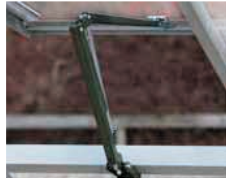
Автоматический открыватель окон Ventomax - Служит для проветривания теплицы, поддерживает температуру воздуха в диапазоне от 16°C до 25°C . Выполнен из оцинкованной стали, вес поднимаемого окна до 7 кг.
